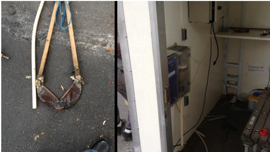
Bild 5: Från provtagningsvagnen som står uppställd vid Skarpnäck under provtagningsstillfällena. Till vänster visas en del av den flödesmätare som använts, ett 90° Thomson skibord.
